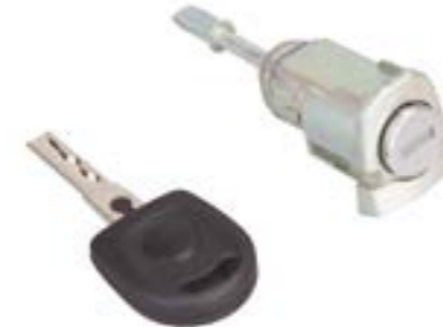
OYS-577 GOLF MK4 RH - B5 RIGHT DOOR KEY PROFILE: HU66 OEM: 1U0837168E
